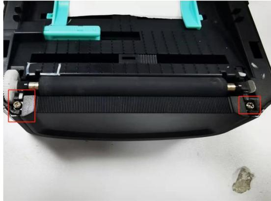
2. 拆掉螺丝后, 把挡板往上提, 拆掉挡板
