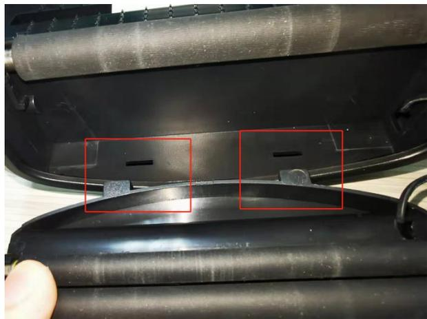
9. 剥离器的螺丝孔卡入卡槽内，用力往里按住图中画圈处，听见“卡”的一声 并装上剥离器螺丝如下图：
