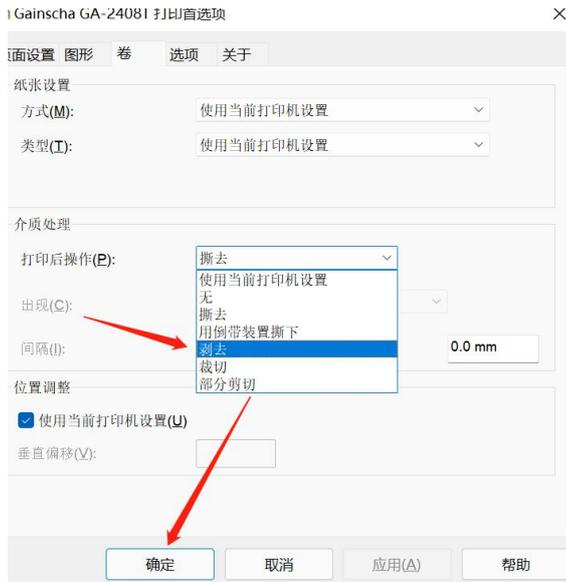
14. 检验剥离器是否安装成功。打开 BarTender 进行打印。看打印机是否有剥离动作。
