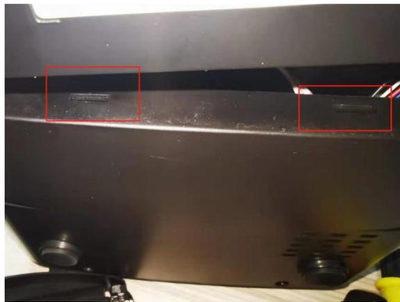
7. 双手按住图中画圈处，往“箭头”方向按听见后底壳发出干脆的声音后装上口底壳螺丝如下图：
